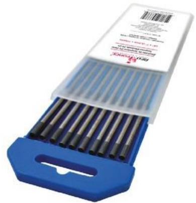
Los electrodos de tungsteno gris ofrecen una ventaja comparándolos con el Standard 2% Torio (electrodos tungsteno rojos) ya que se sustituye este componente (torio) por un 2% de óxido de Cerio manteniendo así excelentes resultados en el inicio del arco y ofreciendo una inigualable estabilidad tanto en DC como en AC.
